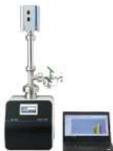
サンプル圧MAX500Pa,質量数範囲1~200amu,取合フランジICF70,TMP70L/s,ダイアフラム型真空ポンプ20L/min,Op.ノートPC,フレキシブルホースSUS製1000mm
