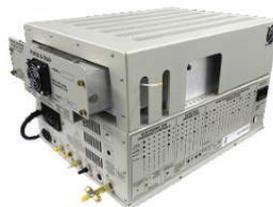
土壌汚染対策法 土壌ガス調査 クロロエチレンを含む第一種特定有害物質測定仕様, PID/DELCD検出器, ノートPC, キャピラリーカラムNBW-310SS60
