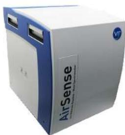
ソフトイオン化質量分析計,質量範囲7~519amu,分解能<1amu,応答時間T90<20msec,低濃度検出限界0.4ppt,再現性<±3%,精度<2%,ガス消費30~3000ml/min,
