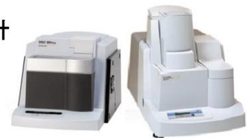
構成: 示差走査熱量計 DSC-60PLUS、
