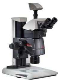
構成: M205FCA本体、電動フォーカス用フットスイッチ、シリアルUSB変換ケーブル、スマートタッチ、ハリアブル三眼鏡筒 5~45度 0/100%、電動フォーカストライプ420mm、他
