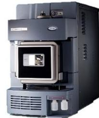
構成:シングル四重極型質量分析装置、HPLCポンプ515、ポンプコントロールモジュールII、ESIプローブ、ノイズカットランス、真空ポンプ SV40BI、制御用PC、窒素ガス精製装置 AT10NPCSM5、システムフルタイムスオーガナイザSFO
