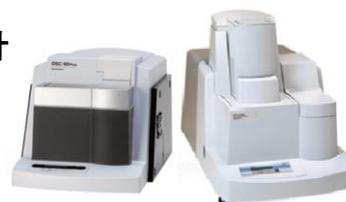
構成: 示差走査熱量計 DSC-60PLUS、
