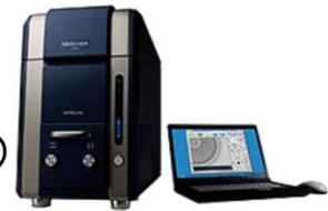
構成: Miniscope TM3030 本体、EDS、ダイヤフラムポンプ、制御用PC、
