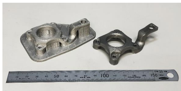
【造形物の一例】右側が土台を除去した造形物 材料：17-4 ステンレス鋼（SUS630 相当）
