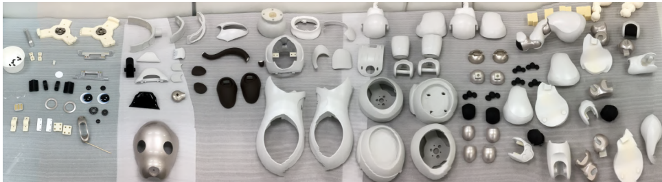
パイボの各パーツはaiboの2倍のサイズで3Dプリンターで出力
