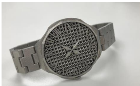
組み立て工程を必要としない一体造形例 金属製の腕時計
