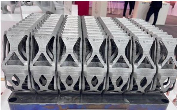
BLT 社製量産部品 (バッテリーハウジング)
